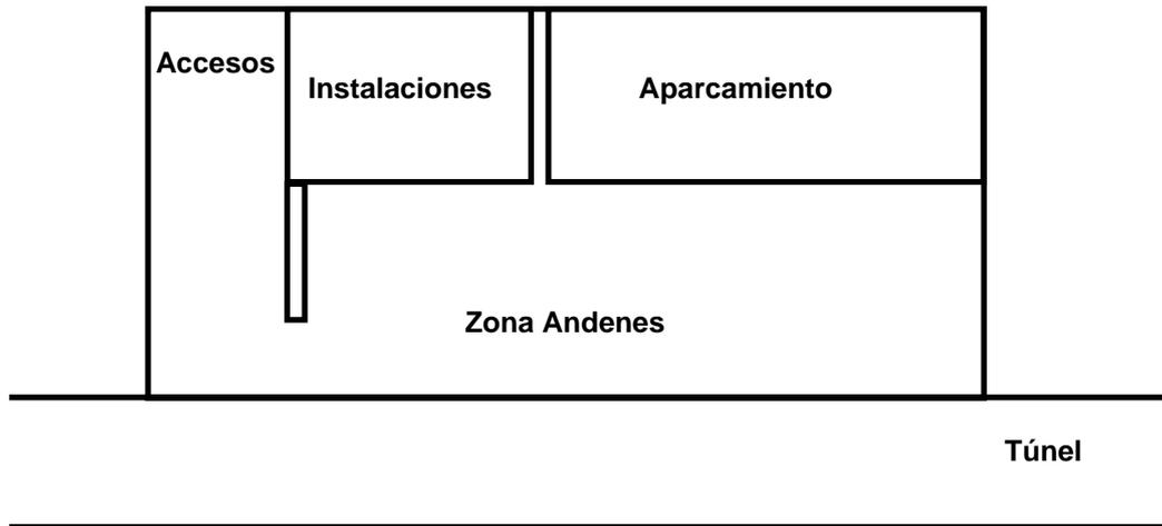
En la estación se tiene de una zona de vestíbulos y accesos hasta las mezaninas y andenes, que constituye una zona a ventilar. Esta zona se ventilará para lograr que las condiciones de los ocupantes en ella sea intermedia a las condiciones que se dan en los coches y el exterior, funcionando así como “zona de acomodación” para los viajeros entre un espacio y el otro.
