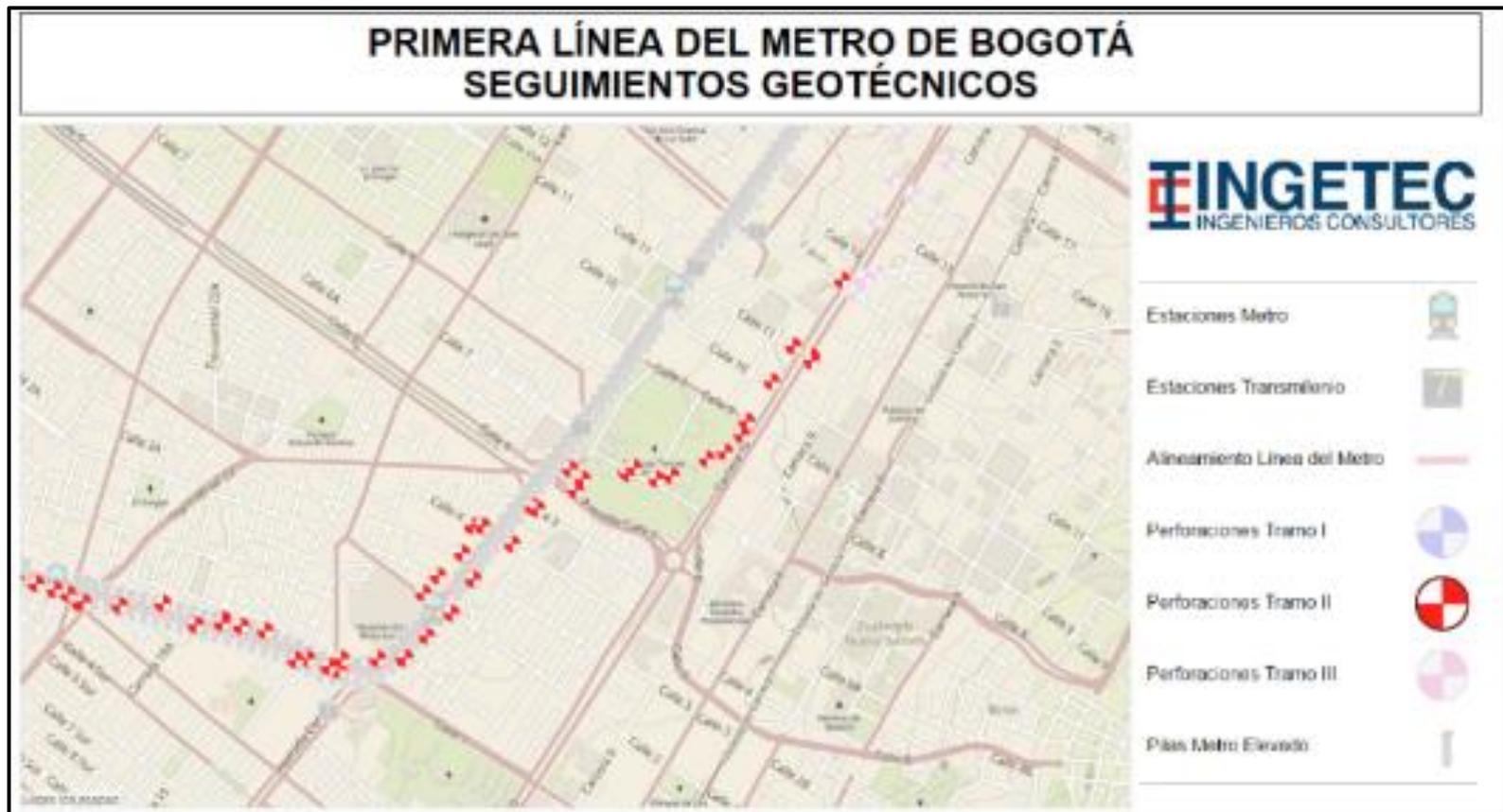
Figura 4.1 Mapa donde se muestran las perforaciones realizadas en 2015, de las cuales solo se tomaron en cuenta aquellas en las que se obtuvo muestra estratigráfica.
