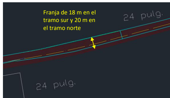
Figura 6.79 Redes afectadas por construcción de viaducto – Fuente: SYSTRA-SIGMA GP
