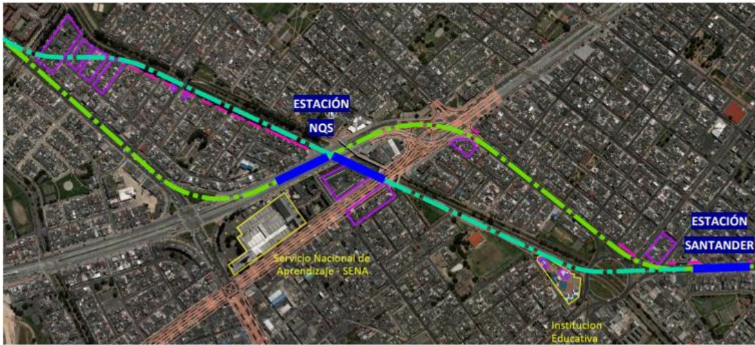
Figura 6.46 Planta comparativa de los dos trazados con las dos opciones de localización de la estación de metro NQS – Fuente: SYSTRA
