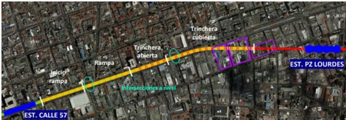
Figura 6.20 Transición infraestructura elevada a subterránea Alternativa Familia C – Fuente: SYSTRA
