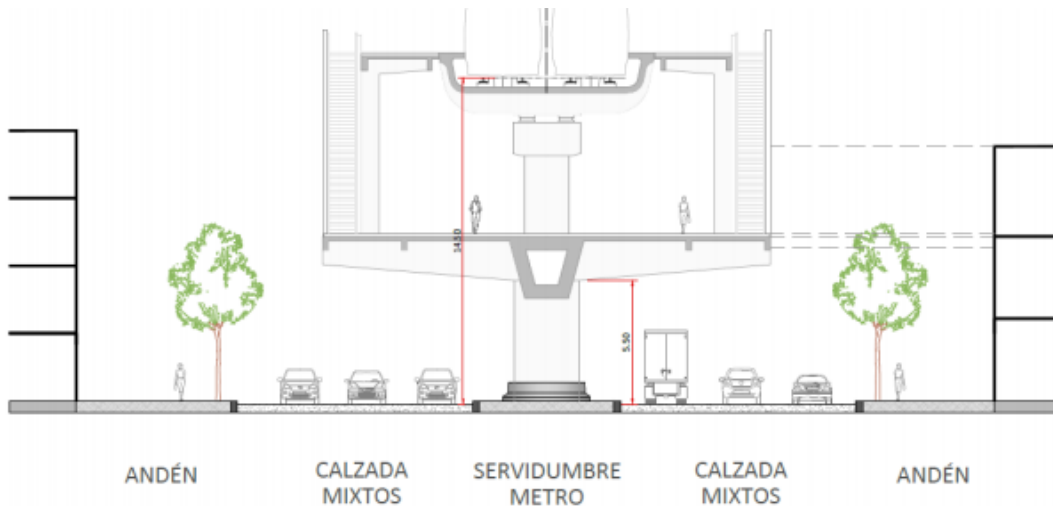
Figura 6.31 Sección tipo Av. Villavicencio con estación Villablanca – Fuente: SYSTRA
