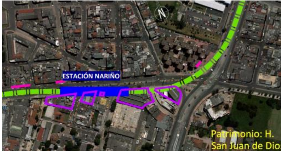
Figura 6.48 Planta de enlace del trazado aéreo entre la Av. Calle 1 y la Av. Caracas, predios impactados en violeta – Fuente: SYSTRA
